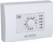
B0151<br><small>hasta agotarse</small> | Kit mando de pared con termostato, selector verano/invierno y selector velocidad. Termostato de pared con sonda ambiente, selector On-Off, selector de tres velocidades ventilador y selector verano/invierno. Rango de ajuste temperatura de 5°C a 30°C. Alimentación de 230 V. Cuenta con dos salidas 230VAC electroválvula agua caliente y electroválvula agua fría y de una entrada sonda temperatura agua.
