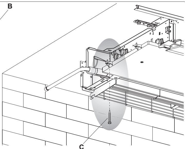
**INSTALACIÓN EN EL TECHO U HORIZONTAL (sólo para el SL, SL SMART)**
