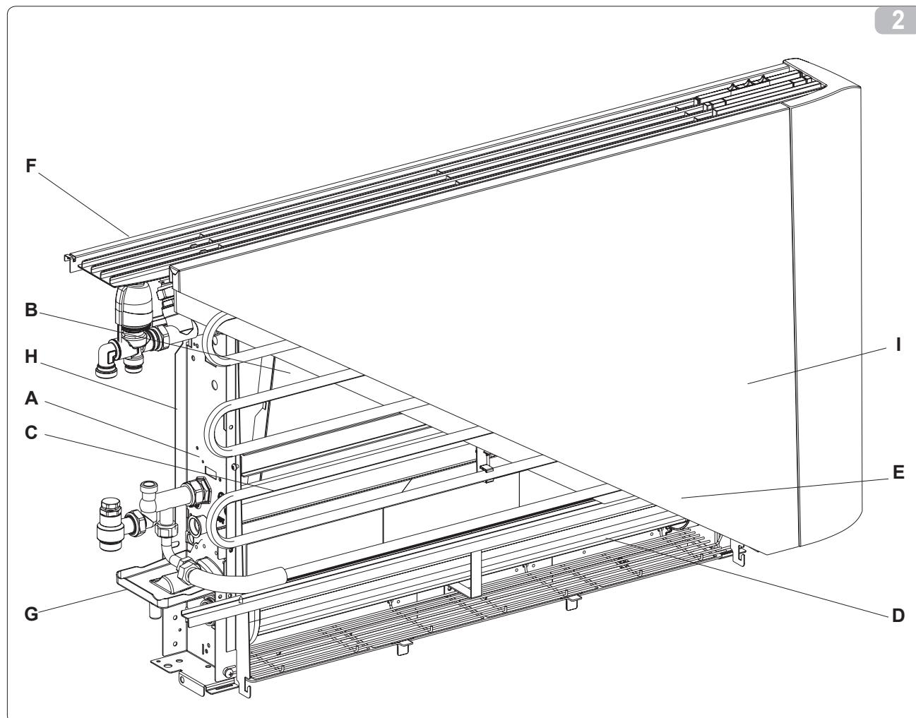
**D - Gruppo ventilante** comprendente ventilatore tangenziale in materiale sintetico ad alette sfalsate (elevata silenziosità) montato su supporti antivibranti in EPDM, bilanciato staticamente e dinamicamente, calettato direttamente sull'albero motore.
