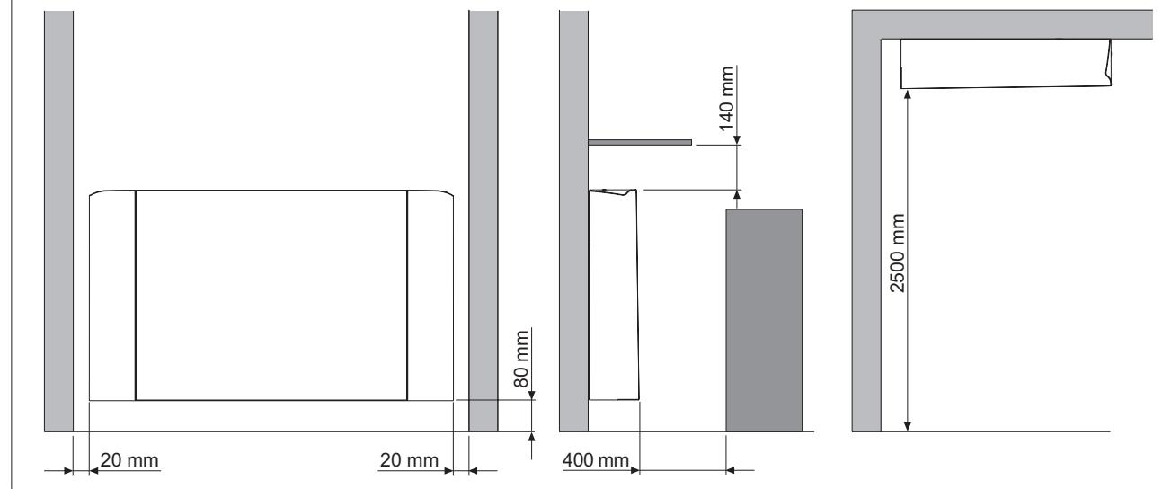
El aparato debe ser instalado en una posición que permita realizar fácilmente las operaciones de mantenimiento ordinario (limpieza del filtro) y extraordinario, así como el acceso a las válvulas de purga de aire (batería y panel), que pueden ser alcanzadas a través de la rejilla superior (en el lado de las conexiones).
