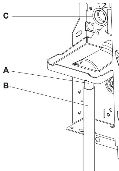
**Montaje del dispositivo de descarga de la condensación en la versión vertical**
