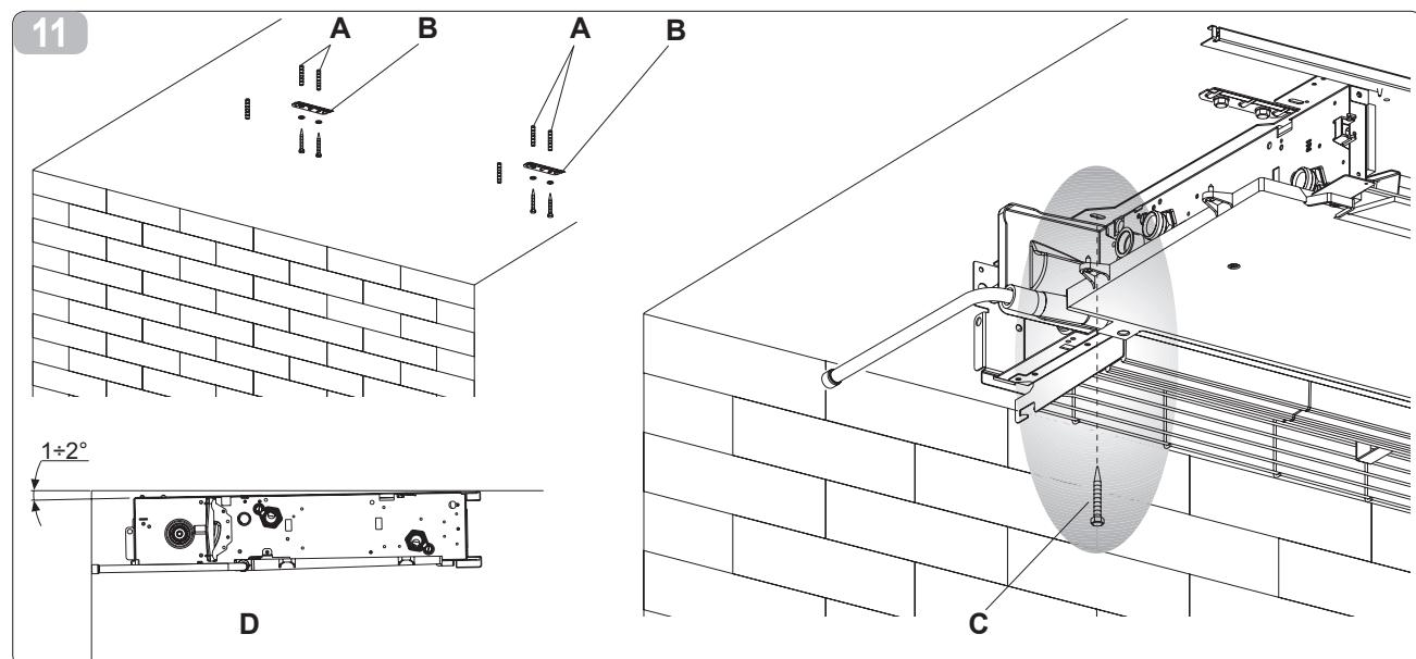
**INSTALACIÓN EN EL TECHO U HORIZONTAL (sólo para el SL, SL SMART)**
