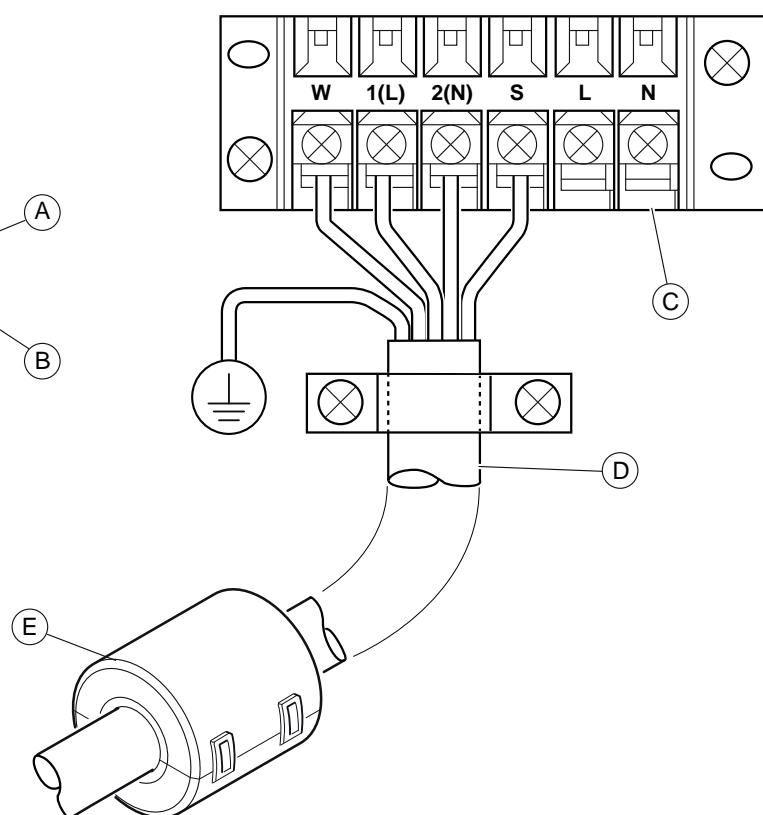
**Conexión del cable a la unidad exterior (fig. 30)**
