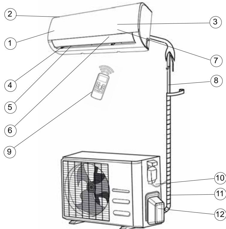
**COMPONENTES DEL SISTEMA (fig. 35)****Unidad interior**
